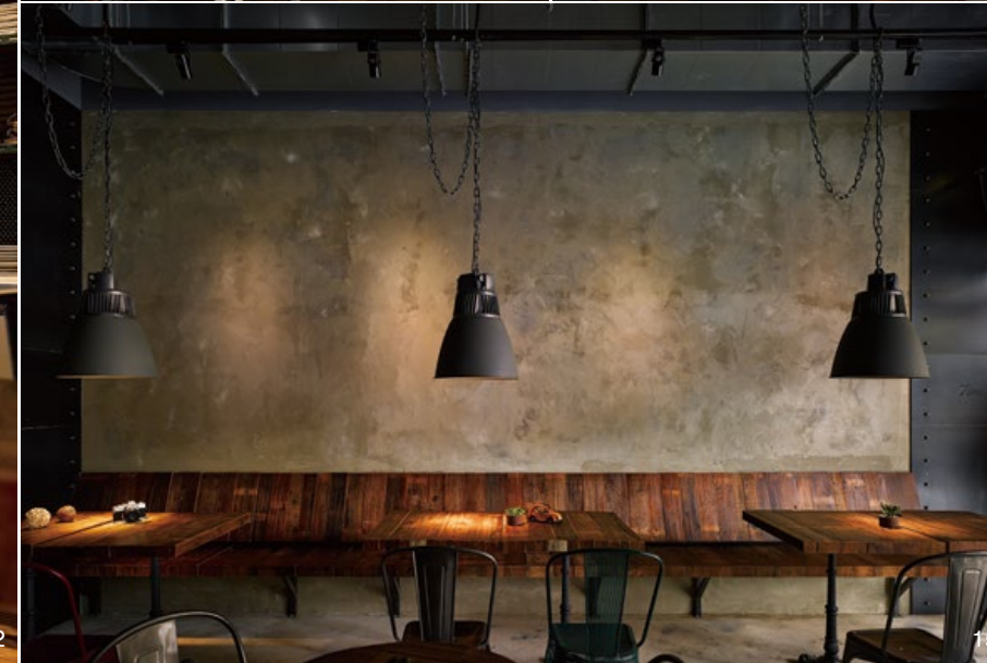
12. 原始管線用黑漆塗上，與天花融合成一個深色襯底背景，新管線用淺色突顯，彷彿塗繪在黑色畫布上的抽象畫，讓天花在線性規律中綻放幾何美感。 13. 吧檯一旁的牆體，利用膠合磁磚之益膠泥鋪覆出儼如油畫的筆觸，用最純粹、簡單的方法表達材料原美。 14. 固定式座位區以舊木料拼貼，洋溢著歲月淬礪之美，與一旁復古家具烘托，相得益彰。 15. 工業感吊燈鐵鍊特意重複一圈垂墜而下，以此舉增添線性層次。 16. 考量多人用餐時的併桌，固定式座位區上方的金屬吊燈能以鐵鍊調整燈具位置。 12. Old utility pipes are all painted in black yet new pipes are painted in light colors 13. Special surface treatment by tile paste to give a handcraft comfort 14. Fixed seats and antique furniture pieces 15. Metal chains and their arrangement 16. Lamp is made of chains and can change to new positions
