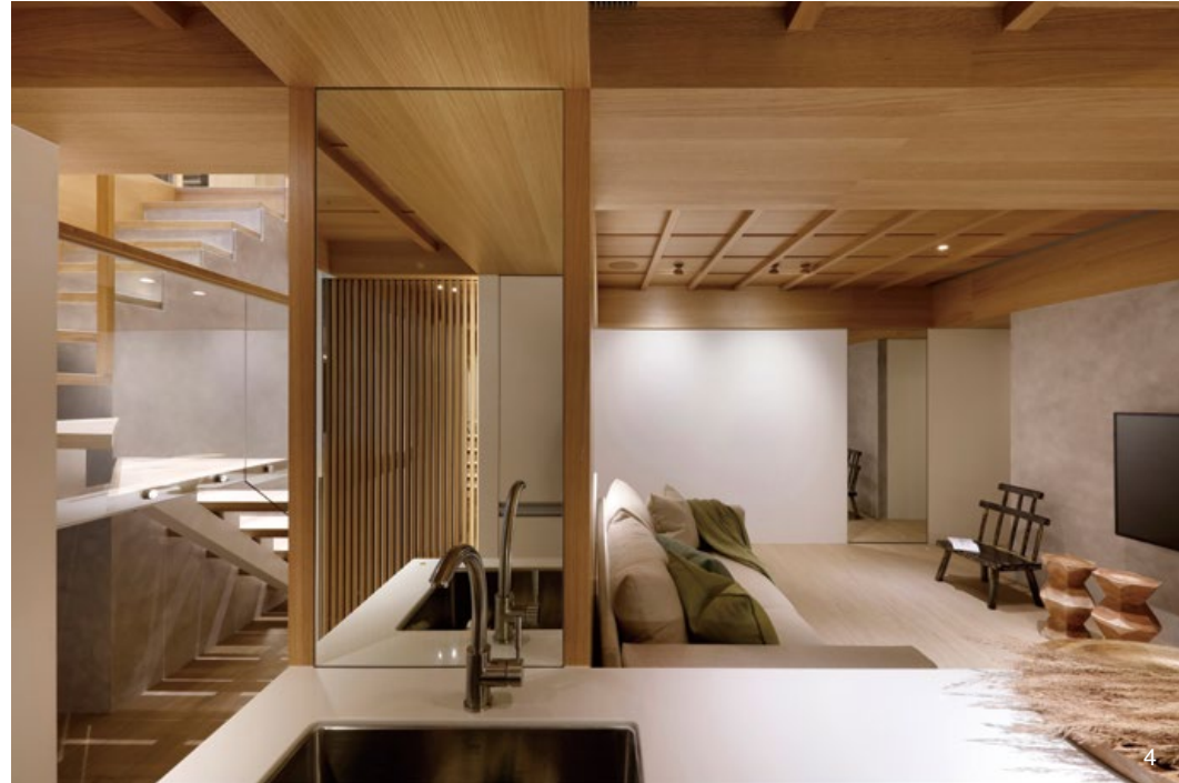
3. 為創造傳統日式建築風情，既有 RC 結構以木材料包覆，並用小樑裝飾天花。吧檯區天花較低乃因藏納管線之故。4. 自料理檯望向樓梯，為不讓垂直動線阻擋窗牖天光和小院景色，設計捨棄一半收納空間，藉輕結構的穿透性引入光和景。5. 長廊後的小起居間與輕食廚房含蓄合宜地作為一種緩衝場域，讓四房兩衛能分立周邊。6. 一樓樓梯旁為衛浴，門片同樣以明鏡處理。7. 一樓衛浴。
