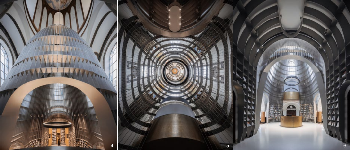
3. 以“church in church”的方式保護歷史建築，體現建築原貌。4. 教堂內的穹頂與特色壁畫、裝飾均做了保留。5. 書架沒有背板，讓穹頂光線灑入主殿內，深刻空間的神聖氛圍。6. 銀色書店裡，把一個小樓座改建成金色講壇，置身講壇可以觀看鋼鐵書店和磚石教堂的並存關係。7. 軸測圖—教堂建築。8. 軸測圖—鋼鐵書店。9. 軸測圖—教堂與鋼鐵書店“church in church”之關係。
