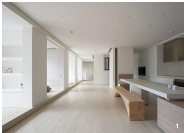
基地為毛胚屋，自然光源大多來自北向光，光量穩定但無法照入室內深處，因此臨窗面的運用相當重要。平面規劃忠實反映業主的需求與生活習慣，全案無明顯隔牆，視線通透能一眼望盡，所有生活機能圍繞中央的中島桌面排置，保留大量走道空間供孩童遊玩，臥房與收納櫃體沿牆面規劃。整體布局整齊，所有牆面維持在統一平面上，線條穩定而有韻律，天花板呈現乾淨一致，間接照明及空調系統隱藏於四周的溝槽內，僅有餐桌上方增加嵌燈。儘管天花板鋪平處理稍微降低空間高度，周正峰卻不擔心產生壓迫感，他認為，樓高在一定視線以上即足夠，當畫面線條簡單的時候，空間視覺就會放大，過多修飾、處理反而更讓人意識到高度的存在。
